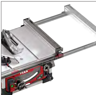
Butée parallèle de haute précision avec système à crémaillère. Les coupes longitudinales sont prises en charge jusqu'à 427 mm à gauche et 780 mm à droite. Réglage très facile et rapide
